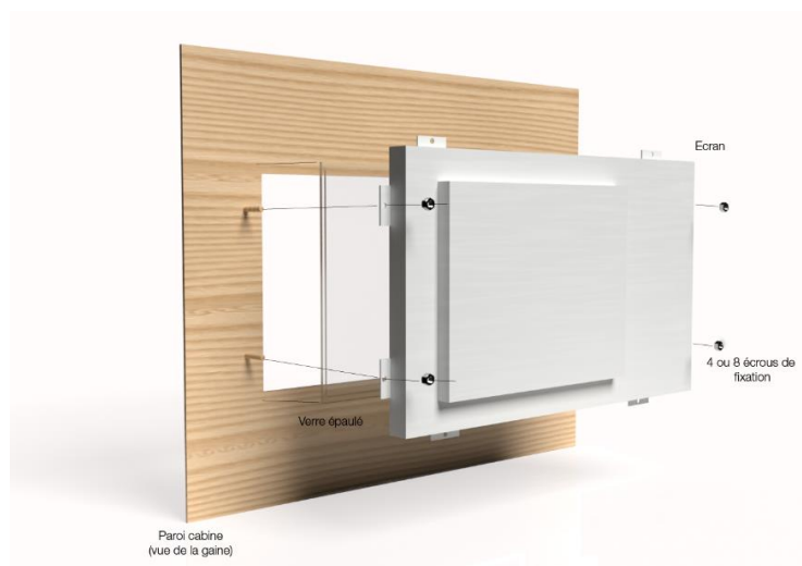
Principe de montage écran à encastrer
