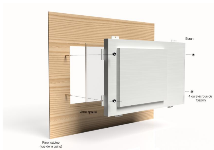
Principe de montage écran à encastrer
